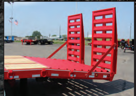
Angle iron ramps - 22", 30", 38", 45" x 6'
